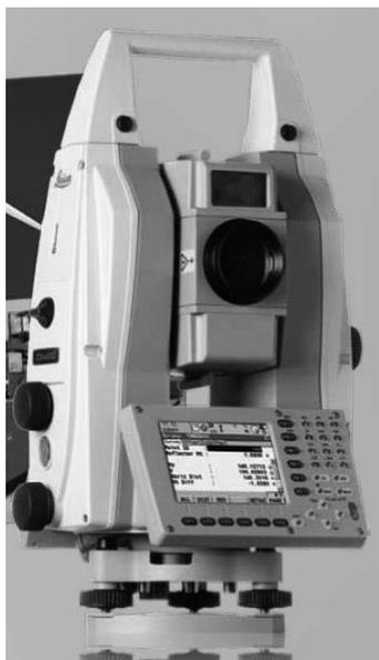
Рис. 2. Тахеометр
