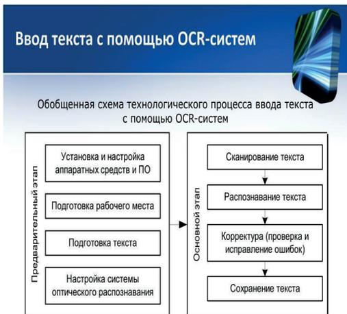
Рисунок 2 – Схема работы OCR
