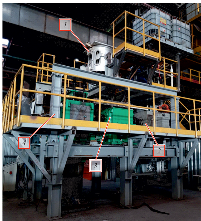
Рис. 1. Установка непрерывного литья и деформации: 1 – индукционная печь; 2 – электродвигатель постоянного тока; 3 – редуктор-синхронизатор; 4 – станина установки
