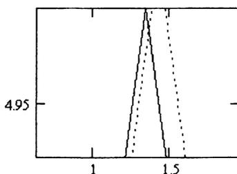
Рис. 5. Траектория движения при  $\Delta t = 0.3$  с модифицированным (сплошная линия) и не модифицированным алгоритмами (точечная линия)
