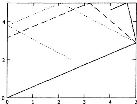
Рис. 10. Траектории движения шара при  $k = 0.1$  (сплошная линия),  $k = 0.5$  (пунктирная линия),  $k = 0.8$  (точечная линия)
