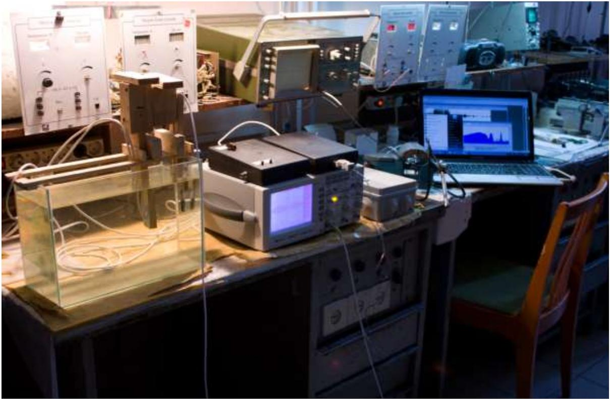
Рис. 6. Внешний вид модельной акустической установки контроля жидкой изоляции
