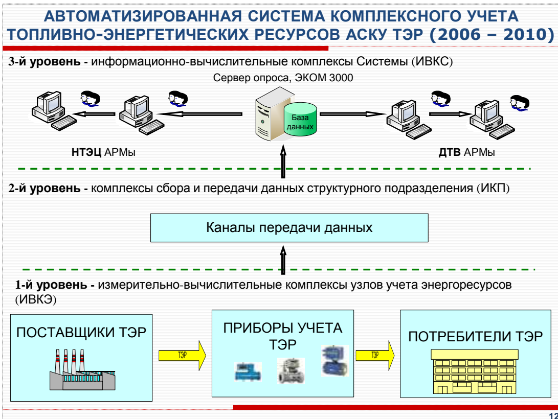
Рис 1. Структурная схема АСКУ ТЭР ОАО «РЖД»
